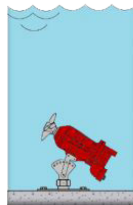
Instalación anclada al fondo del tanque
